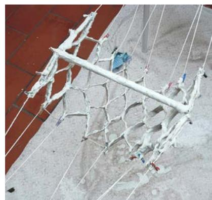
Fig. 23 Modelo en franjas de papel embebido en cemento blanco. La malla está colgando para generar la forma por gravedad durante el proceso de secado. ©Ludovica Rossi 2012
