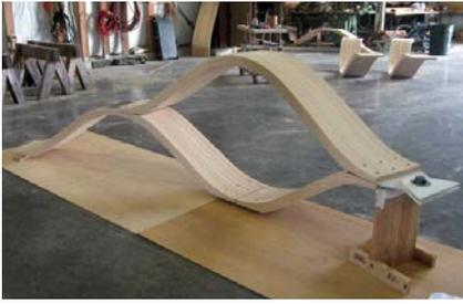
Fig. 20 Módulo en madera laminar del pabellón del Lincoln Park Zoo South Pond (Chicago, EE. UU.) diseñado por GANG Architects. © Studio Gang 2010
