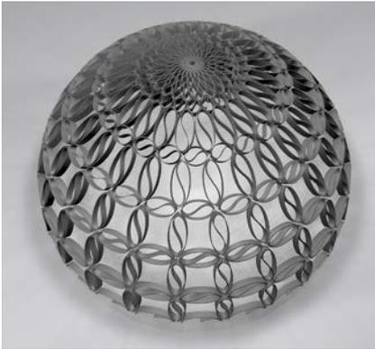
Fig. 34 Pruebas de modelos esféricos obtenidos por clonación del arquetipo según un objeto esfera. La iteración no permite adaptar las franjas a la porción de curvatura de la superficie, donde los cuerpos se entrecruzan y sobreponen entre sí. © Ludovica Rossi 2016
