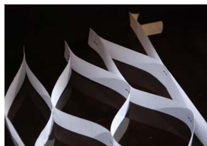
Fig. 7 Modelo de malla en franjas de papel con uniones regulares y alternadas abierta por tracción. © Ludovica Rossi 2010
