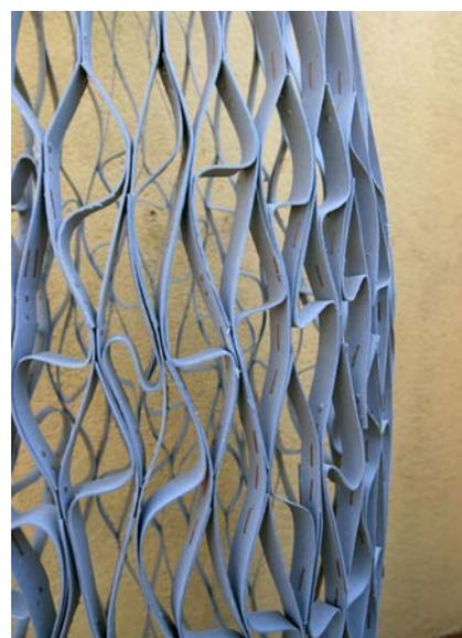
Fig. 40 Maqueta en fibras de papel unidas de forma regular y alternadas, con la inserción de fibras de largo diferente. La forma del cilindro se obtiene por empuje internos entre las fibras que abren el tejido. © Ludovica Rossi 2010
