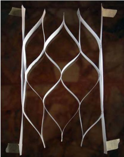
Fig. 8 Modelo en franjas de papel unidas de forma alternada y regular. La malla queda abierta por la aplicación de esfuerzos de tracción en los cuatro extremos y la diferencia de apertura entre las bandas muestra la variación de las tensiones en la trama. © Ludovica Rossi 2010
