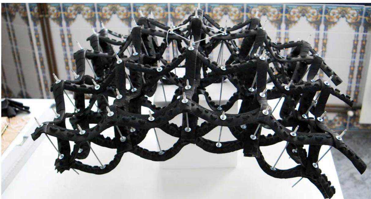
a reproducir los pasos realizados en las primeras pruebas en papel. La comparación entre los diferentes resultados obtenidos pone en evidencia el comportamiento altamente elástico y flexible de las bandas neumáticas. Este ofrece altas prestaciones de flexibilidad que permiten investigar las condiciones de los cambios morfológicos analizados en el tejido vivo del cactus.
