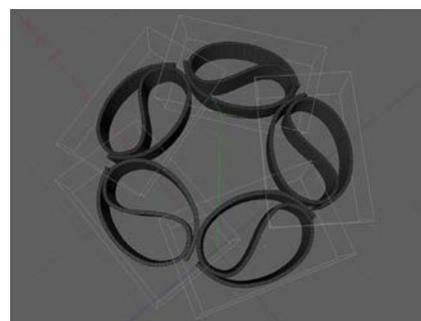
Fig. 33 Construcción del primer anillo que compone la cúpula por medio de la iteración por rotación e inclinación según la tangente en la porción de esfera correspondiente. © Ludovica Rossi 2016
