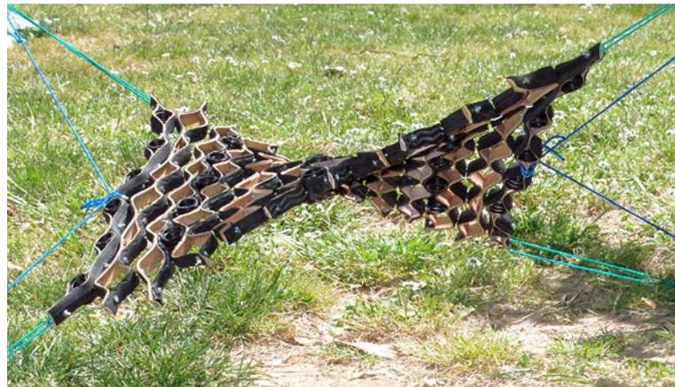
Fig. 38 (Abajo) Modelos en bandas pre-deformadas y unidas sucesivamente: **a)** Modelo en pétalos alternados y unidos según los paralelos de una cúpula; **b)** Modelo por sumatoria de franjas cortas pre-deformadas en S cerradas, la morfología general es similar a un conoide. © Ludovica Rossi 2015
