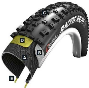
Fig. 42 La cubierta de una bicicleta para neumáticos con cámara de aire se compone principalmente de las siguientes capas: **a)** la carcasa compuesta por diferentes tejidos recubiertos de goma; **b)** los flacos laterales con una capa extra reforzada, **c)** la banda de rodadura; **d)** según el modelo puede tener una capa adicional de protección antipinchazos, **e)** los aros del borde que aseguran el ajuste del neumático a la llanta. © Bike 2018
