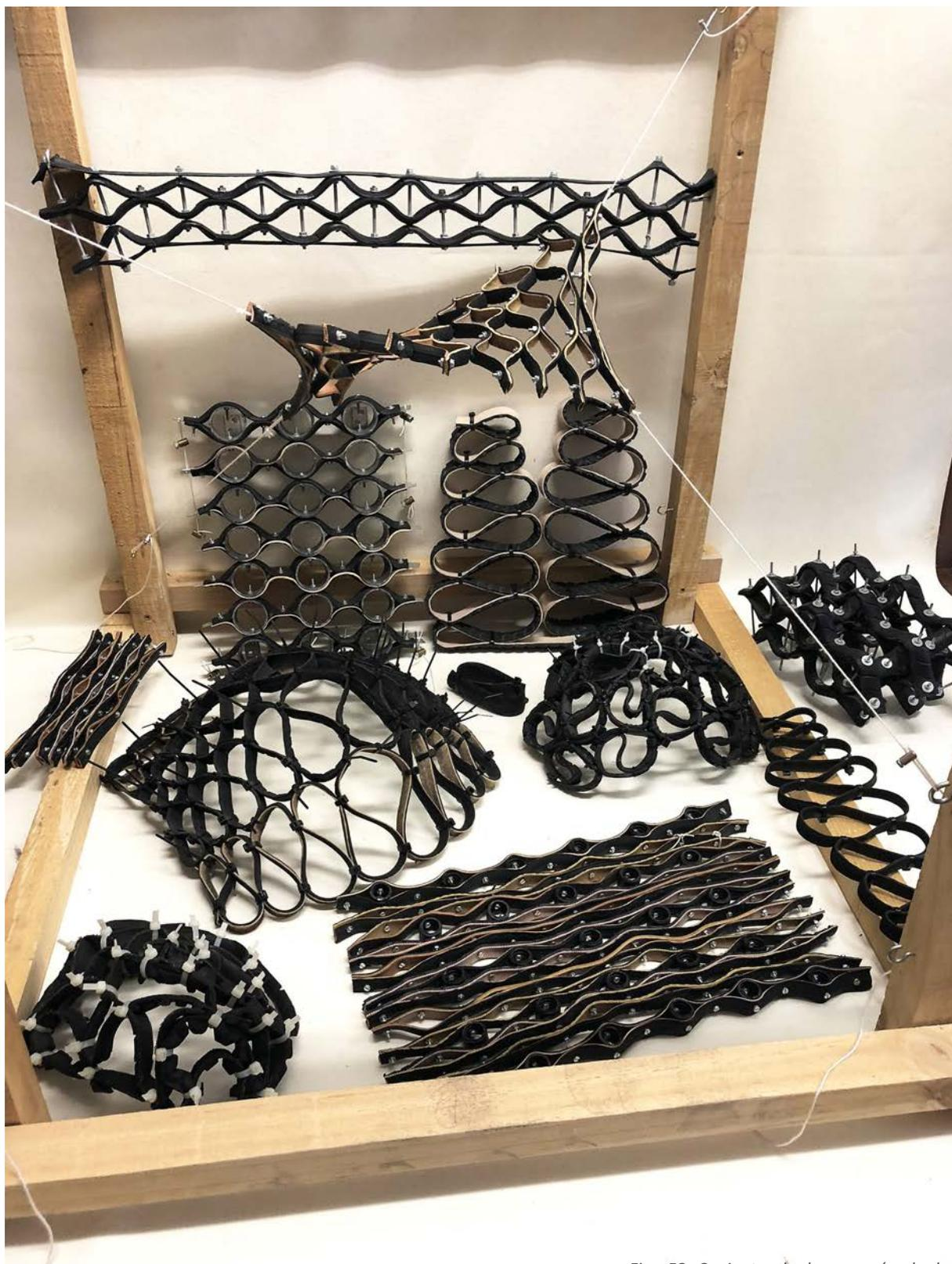
Fig. 53 Conjunto de la mayoría de los modelos físicos realizados en banda de rodaduras de los neumáticos de bicicletas recuperados. ©Ludovica Rossi 2011÷2017
