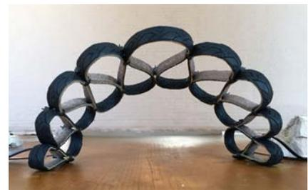
Fig. 28 El acercamiento entre sí de los dos extremos de la franja pre-deformada en pétalos alternados, genera la forma de un arco que soporta su propio peso. Las dos deformaciones generan una configuración autoportante. © Ludovica Rossi 2015
