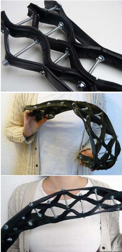
las franjas abiertas, sin ninguna deformación externa aplicada previamente, se adaptan a las acciones internas generadas por la introducción de los elementos rígidos sin ejercer mayor resistencia.
