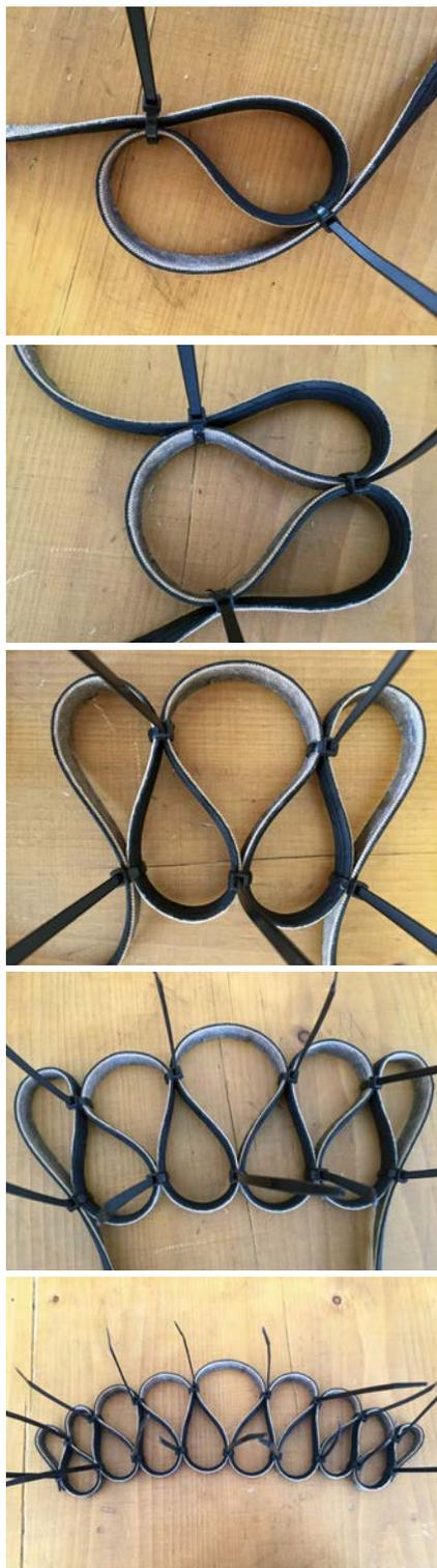
Fig. 26 Secuencia de generación de la forma en un sistema de flexión activa obtenido por geometría. La banda cambia su geometría de un elemento lineal fino a un elemento plano donde el ancho es mayor que el alto. © Ludovica Rossi 2015
