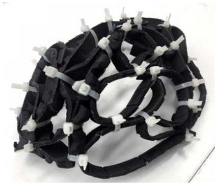
Fig. 23 Modelo de una superficie sinclástica obtenida con una banda continua de neumático doblada sobre si misma, siguiendo curvas invertidas y fijada de forma aleatoria con bridas de plástico. ©Ludovica Rossi 2015
