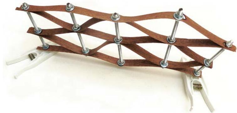
Fig. 17 Relaciones de esfuerzo entre franjas de madera delgadas (ancho 1 cm) de largo diferente y unidas en sí. La franja inferior de menor longitud está sujeta a tracción, y la superior de mayor longitud a compresión. El equilibrio entre los esfuerzos contrapuestos actúa abriendo las franjas. © Ludovica Rossi 2011.
