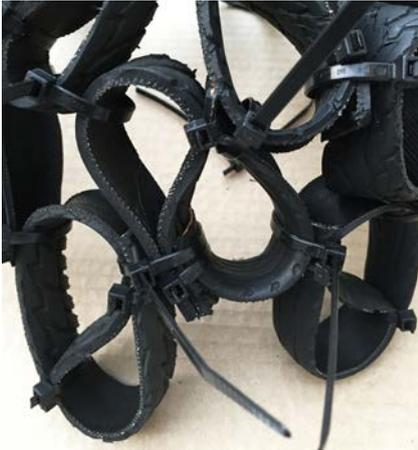
Fig. 38 Detalle unión franjas cerradas en anillos. © Ludovica Rossi 2015
