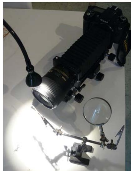
Fig. 1 Utilización de la máquina fotográfica con el objetivo macro y un fuente de ampliación óptica para la observación y documentación de las muestras de tejido de cactus seco. © Ludovica Rossi 2011
