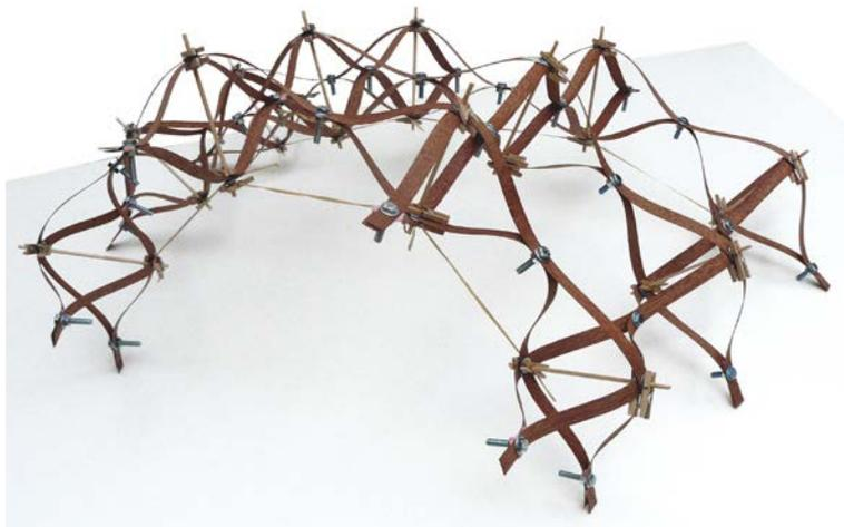
Fig. 31 Experimento con un entramado tridimensional de doble nivel en banda de madera realizado en julio de 2011, que está inspirado en el ejemplo de la instalación HybGrid realizada por S. Felipe y J. Truco, en 2004 a la Architectural Association School de Londres. © Ludovica Rossi 2011
