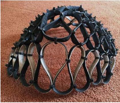
Fig. 31 Modelo donde la agregación de franjas pre-deformadas en pétalos alternados con dimensiones variables permite obtener la morfología de la cúpula, una superficie a doble curvatura positiva que puede soportar su propio peso. Las franjas separadamente son planas, y cuando se unen empiezan a curvarse hasta formar la cúpula. © Ludovica Rossi 2015
