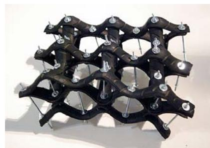
Fig. 35 Modelo en bandas de rodadura de bicicletas con dos niveles de urdimbre y extensión 25x16 cm. ©Ludovica Rossi 2011
