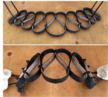
Fig. 27 La franja pre-deformada se curva por acercamiento de sus extremos, el comportamiento es similar a un cuerpo plano sometido a flexión que se arquea por pandeo. © Ludovica Rossi 2015
