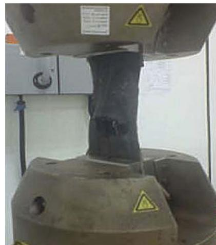
Fig. 47 Testigo de banda de neumático fuera de uso (NFU) modelo 175/70 R13 en la prueba de resistencia a tracción. La tensión de tracción es aplicada a una velocidad de deformación establecida en un 10% por minuto hasta la rotura de la prueba. © Safari at all, 2011
