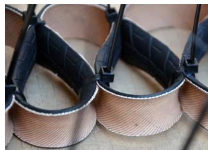
Fig. 40 Modelo franja pre-deformada en forma de pétalos alternados. Detalle de la unión con bridas de plástico que actúa como un encaje entre las secciones de las dos fibras en la zona de acoplamiento.
