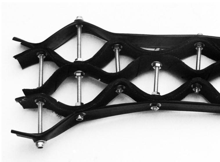
Fig. 33 Modelos de un nivel de urdimbre en banda separadas por varillas metálicas. Las franjas centrales son en banda de rodadura de bicicletas reutilizadas y las externas en cámara de aire. © Ludovica Rossi 2011
