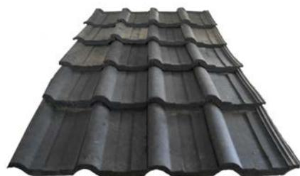
Fig. 24 Teja en caucho reciclado de NFU para cubiertas inclinadas desarrollada por la ONG CEVE (Centro Experimental de la Vivienda Económica) en colaboración con CINTEMAC, Universidad Tecnológica Nacional (Argentina). Está elaborada con neumáticos fuera de uso procedentes de desechos. El procedimiento de elaboración consiste en el triturado, la extrusión, y el moldeado en prensa. © CEVE 2015
