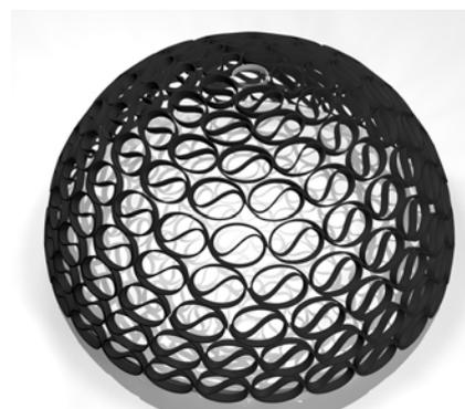
Fig. 32 Modelo compuesto por 9 anillos concéntricos cuyos elementos base varían de un mínimo de 5 a un máximo de 28, radio de la cúpula 320 cm. © Ludovica Rossi 2016
