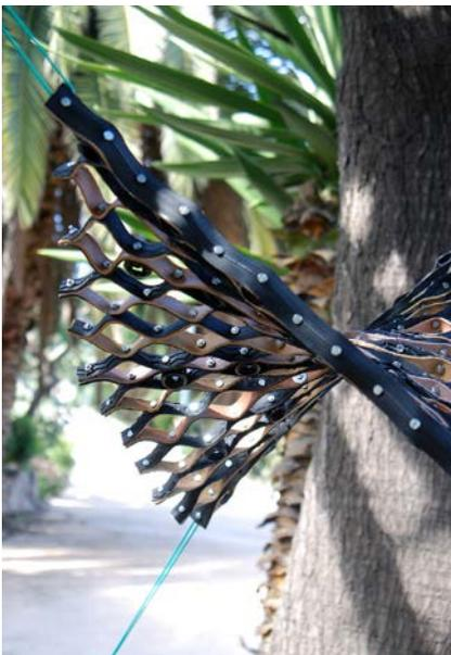
Fig. 3 Malla compuesta por franjas unidas de forma regular alternadas, con tuercas y tornillos. Al ser tensada la superficie se curva en forma de paraboloides hiperbólico y las fibras asumen una trayectoria sinusoidal. © Ludovica Rossi 2013
