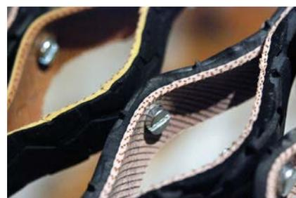
Fig. 39 Modelo de una malla sinusoidal regular. Detalle de la unión con tornillos y tuercas que actúa como una bisagra en el punto de fijación entre dos fibras.
