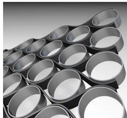
Fig. 3 Simulación 3D modelo en franjas sinusoidales con actuadores externos en forma cilíndrica, la deformación general de la malla en forma de silla de montar. ©Ludovica Rossi 2013
