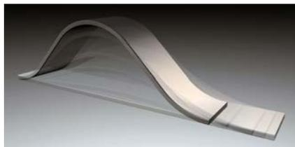
Fig. 24 Simulación 3D de la propiedad de modificación de la franja de plana a curva en la malla regular por las propiedades elásticas intrínsecas del material. ©Ludovica Rossi 2012
