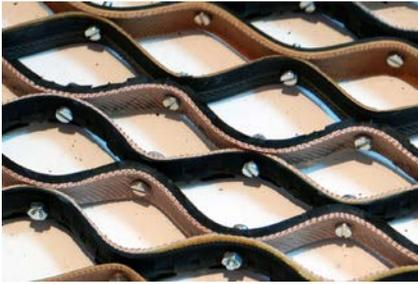
Fig. 9 Modelo de una malla sinusoidal regular: altura de 1,5 cm, uniones entre dos franjas cada 7 cm, translación de las uniones para obtener la malla romboidal 3,5 cm. © Ludovica Rossi 2013
