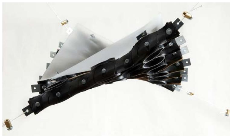
Fig. 44 Vista lateral de un modelo de malla sinusoidal regular con actuadores externos cilíndricos, altura de las franjas 2 cm, núm. total de franjas 14. © Ronald Stallard 2014
